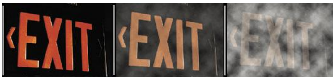
Fig. 8 – In pochi minuti i fumi densi e opachi, emessi durante un incendio dai cavi che bruciano, riducono la visibilità ostacolando il raggiungimento delle vie d'uscita.
